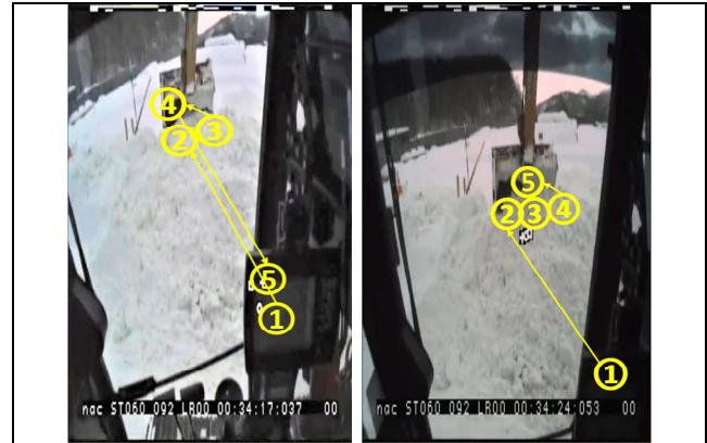
図-5 未熟練オペレータの作業確認点
