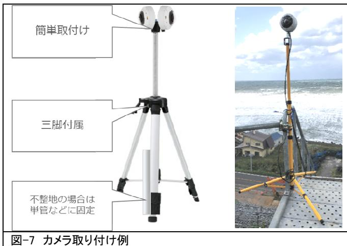
図-7 カメラ取り付け例
