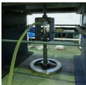
写真-4 バキュームパッド設置状況
