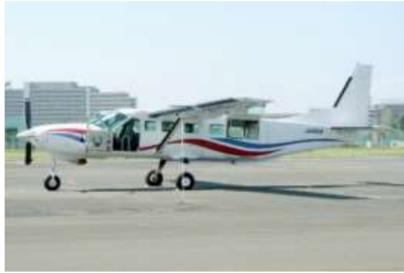
図-5 航空レーザ搭載固定翼機
