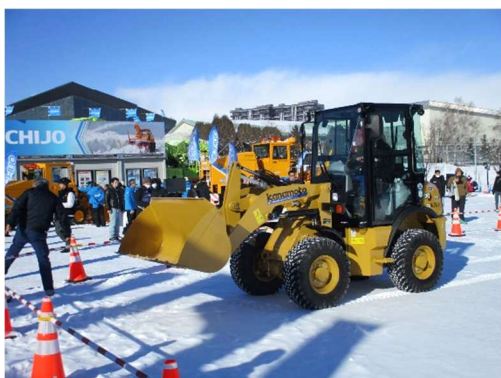
写真 23 (株)カナモト タイヤショベル 0.4m 3 、接触防止センサー付
