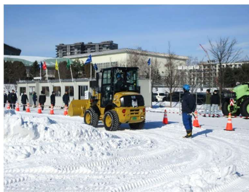
写真 23 (株)カナモト タイヤショベル 0.4m 3 、接触防止センサー付
