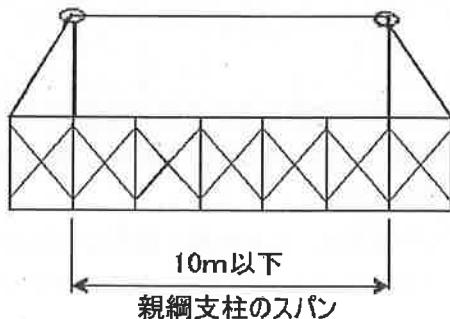
イ 親綱支柱を設置した作業床と衝突のおそれのある床面等との垂直距離 (H) に応じて使用することのできる親綱支柱のスパン (L) は、次式により算出した値以下であること。ただし、Hは3.8m以上を確保すること。
